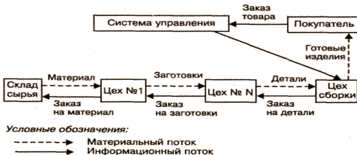
Рис.16 - Тянущая система управления материальным потоком на производстве
