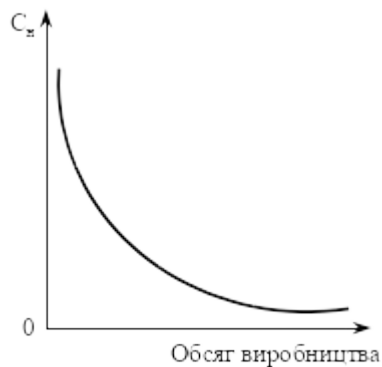
Рис. 4.2. Зміна собівартості нового складного виробу в процесі освоєння серійного виробництва
