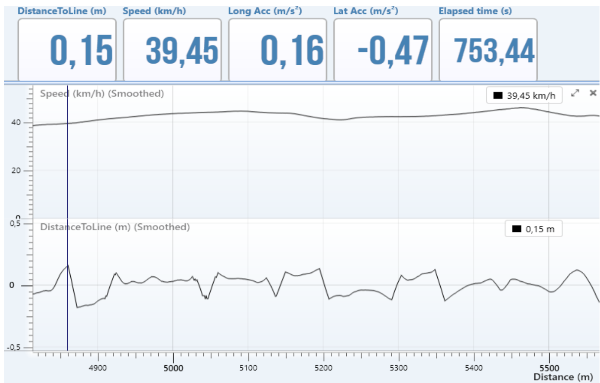
Рис. 3 – Приклад реєстрації параметрів руху за допомогою GPS
