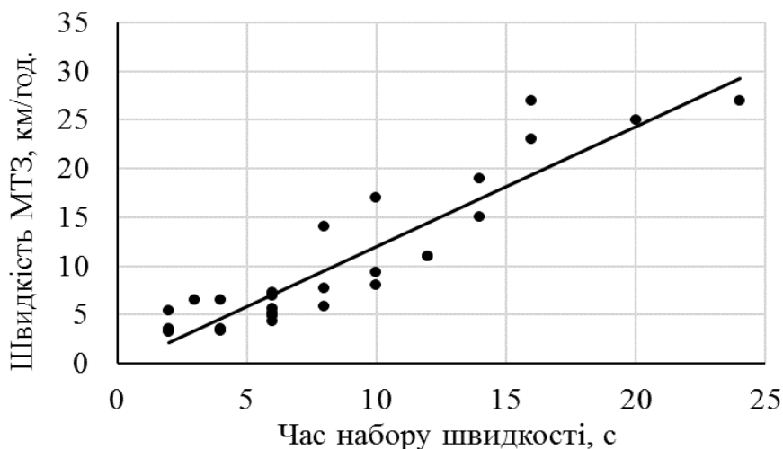
Рис. 3.17. Експериментальна та теоретична залежності швидкості від часу руху при від'їзді МТЗ від ЗП
