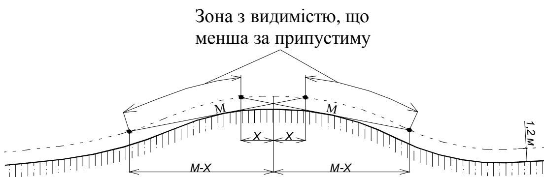
Рис. 1.16. Вертикальна крива з зонами видимості менше допустимої, що не доходять до вершини кривої
