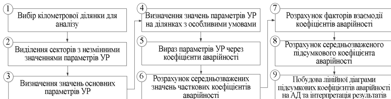
Рис. 3.5. Етапи визначення рівня БДР
