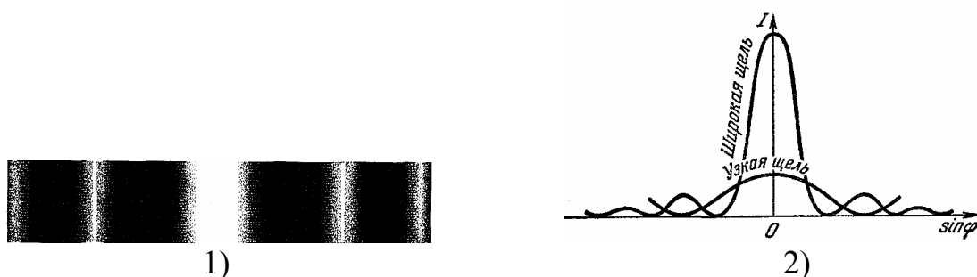
Рисунок 12 – Изменение дифракционной картины с увеличением ширины щели: 1 – фотографии дифракционных полос; 2 - графические распределения интенсивности света в дифракционных полосах
