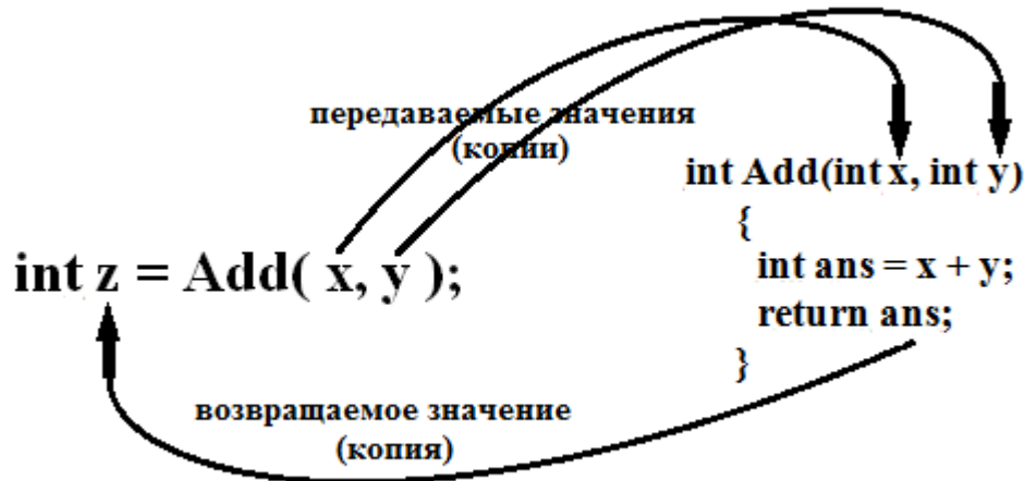
Рис. 2. Обмен значениями при вызове функции Add(x,y)
