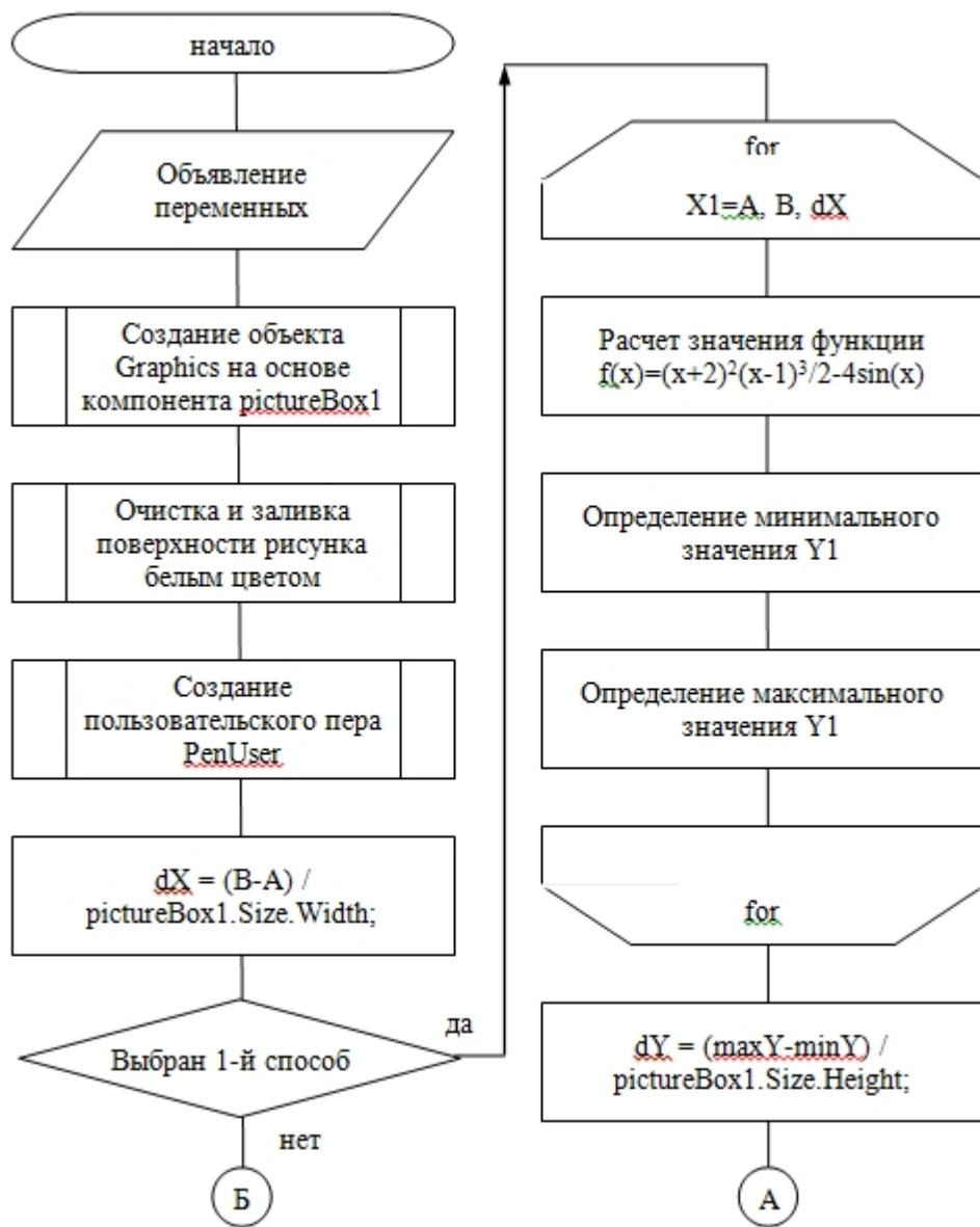
Рисунок 4 – Блок-схема обработчика события button1\_Click
