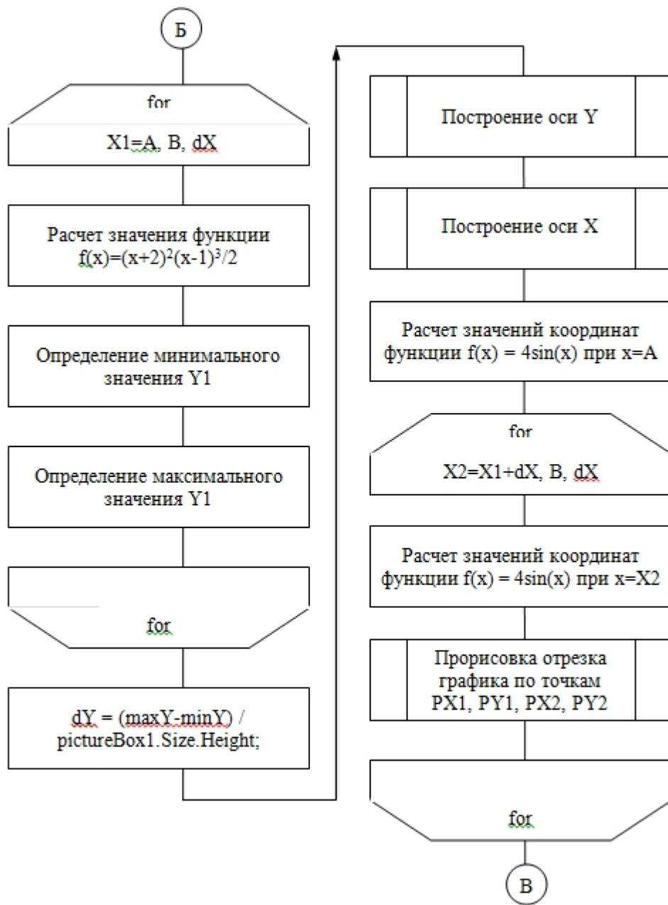
Рисунок 4 – Блок-схема обработчика события button1\_Click (продолжение)
