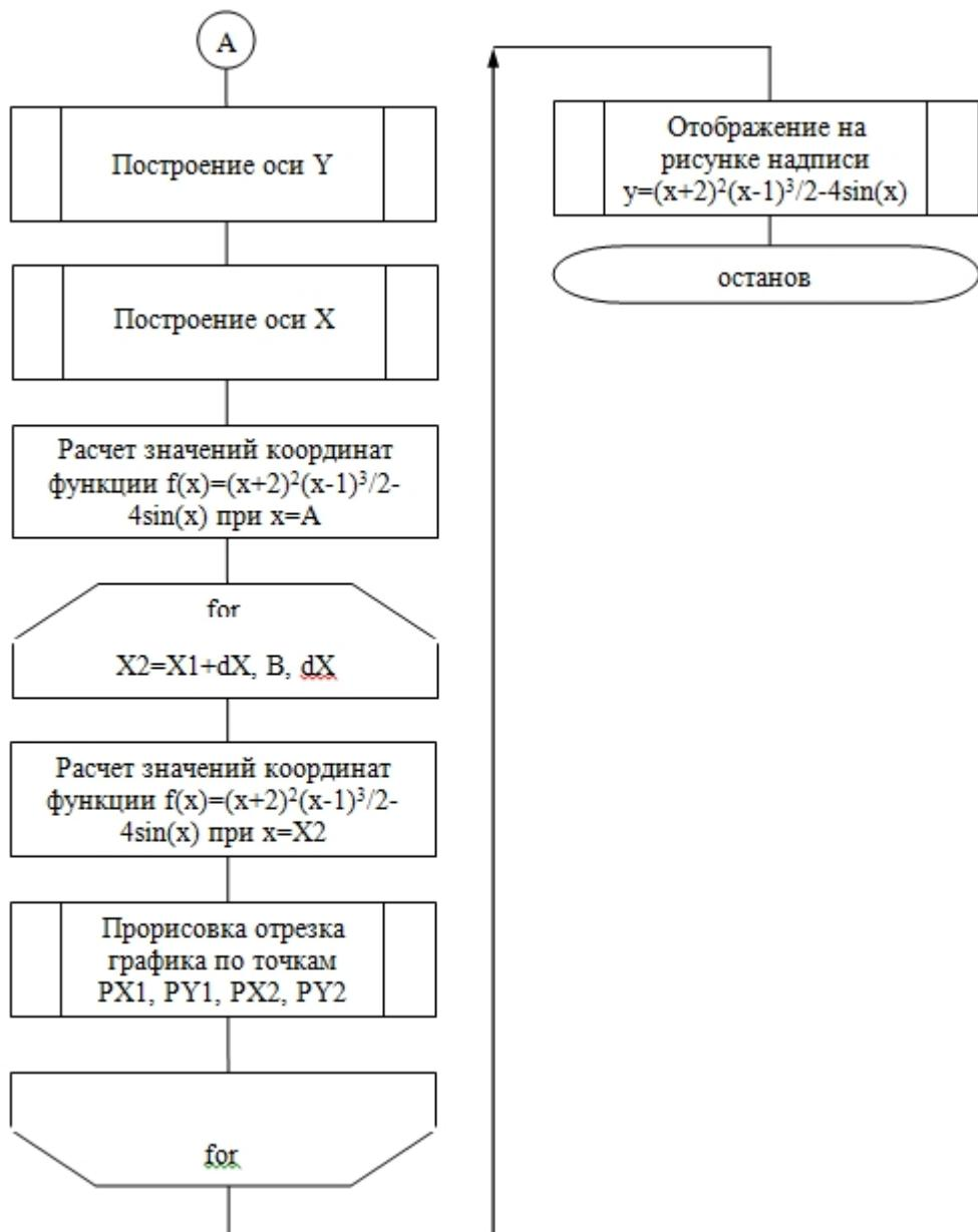
Рисунок 4 – Блок-схема обработчика события button1\_Click (продолжение)
