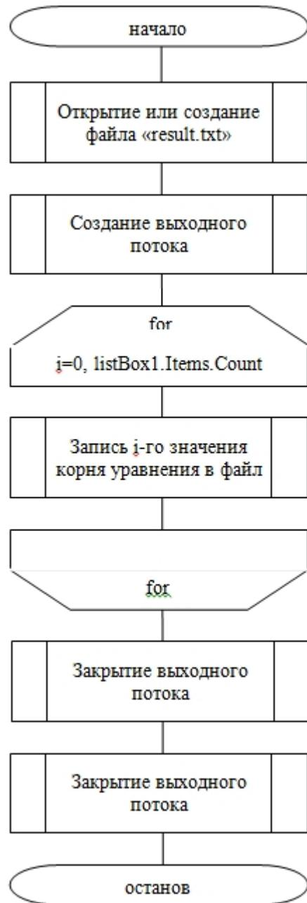
Рисунок 5 – Блок-схема обработчика события button2\_Click
