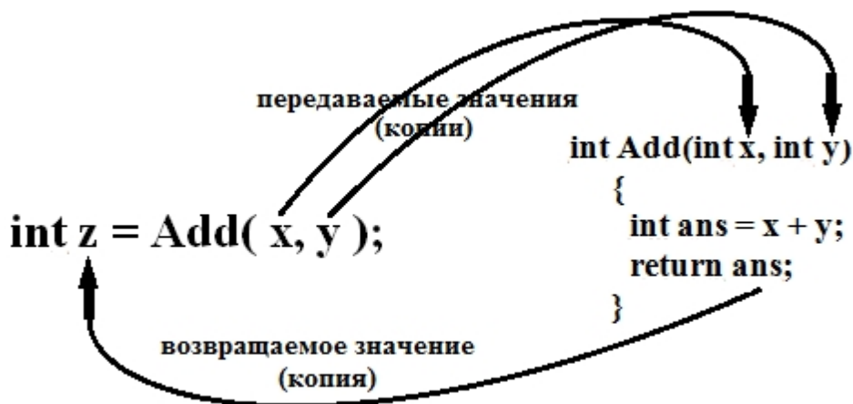
Рис. 2. Обмен значениями при вызове функции Add(x,y)
