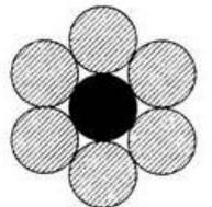
Схема провода марки АС
