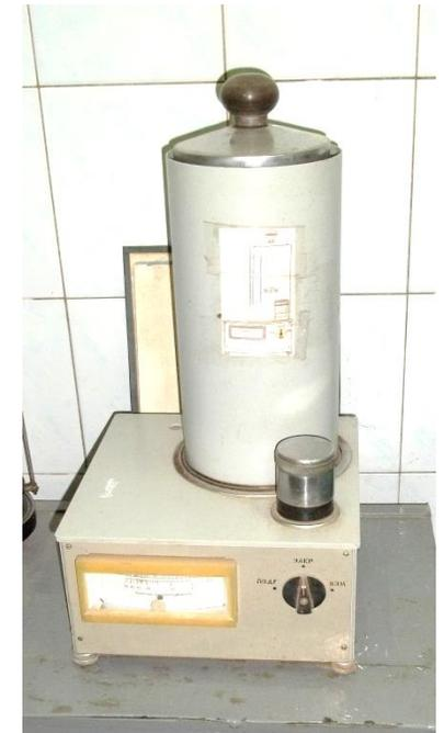
Испытания проводят на трех образцах. Значение газопроницаемости определяют как среднее арифметическое из трех полученных данных.
