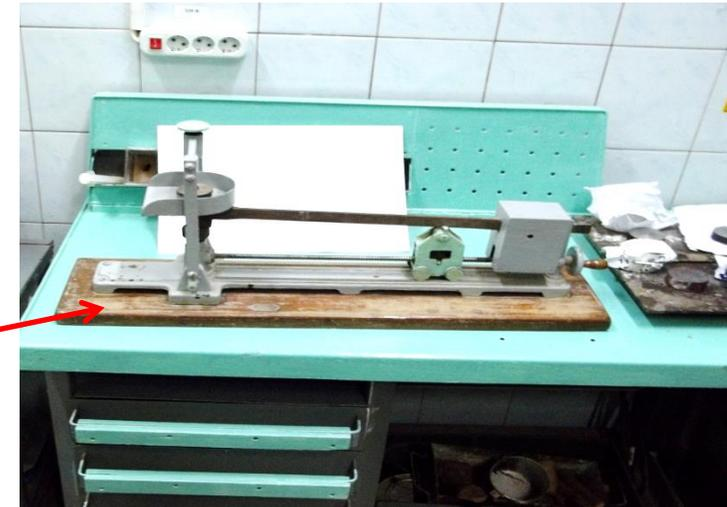
7. Определить **прочность** на сжатие в сыром состоянии с помощью рычажного прибора на тех же трех образцах, на которых определяли твёрдость. Для этого с помощью специального выталкивателя образец осторожно извлекают из гильзы и устанавливают на площадке прибора. Испытания проводят на трех образцах, значение прочности принимают как среднее арифметическое трех определений.
