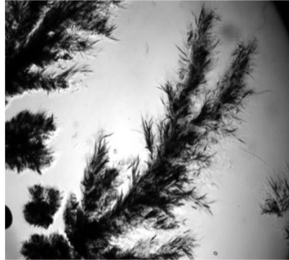
Дендрит в металлическом расплаве.
