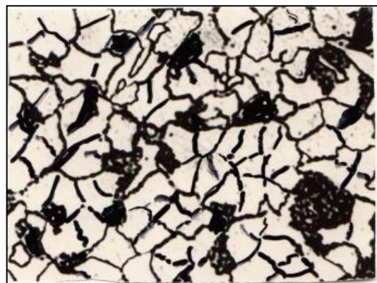
Структура стали после первичной рекристаллизации (отжига)
