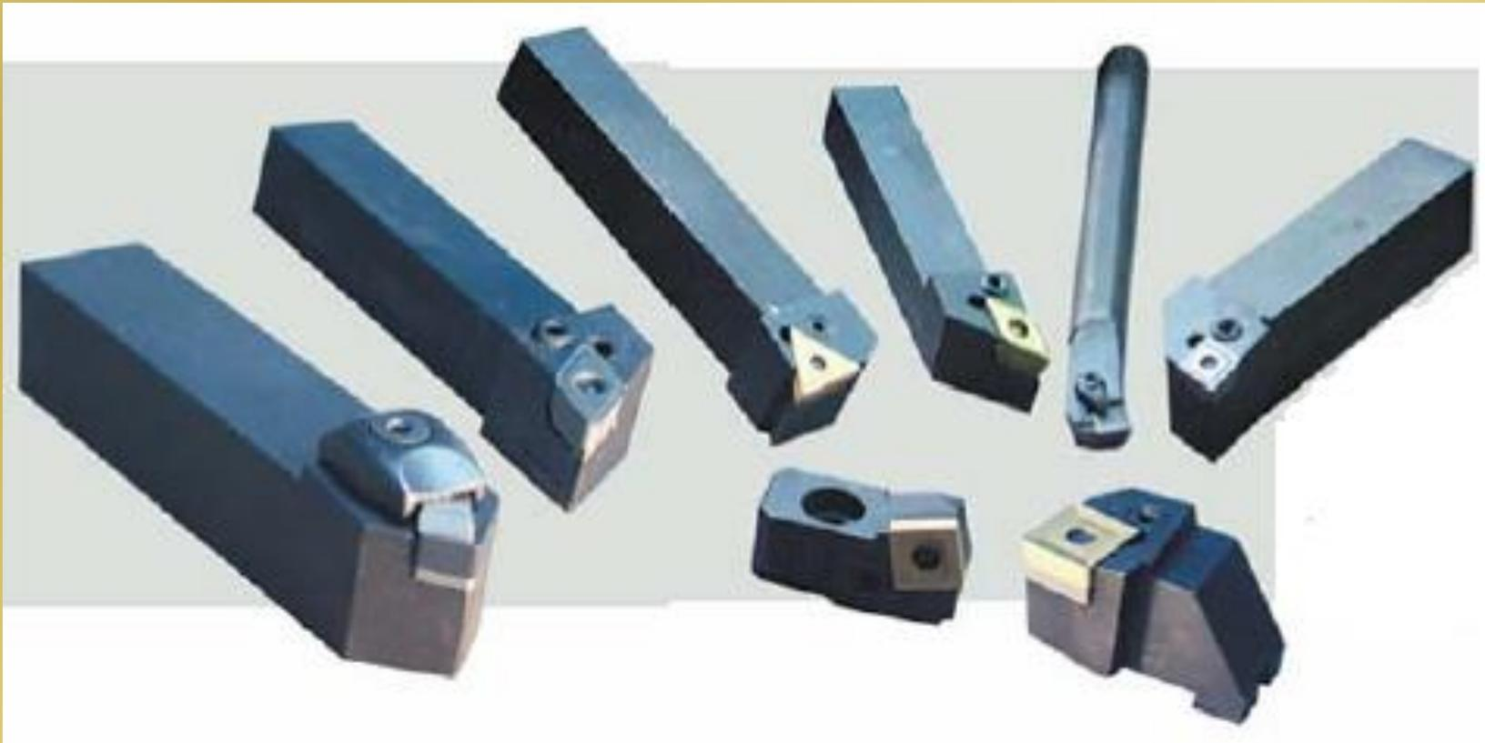
Широкое применение находят сборные разъёмные резцы с механическим креплением многогранных пластин.
