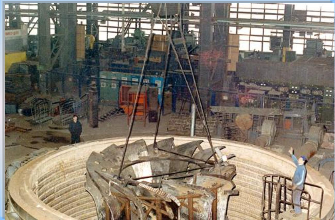
Химико-термическая обработка (азотирование)
