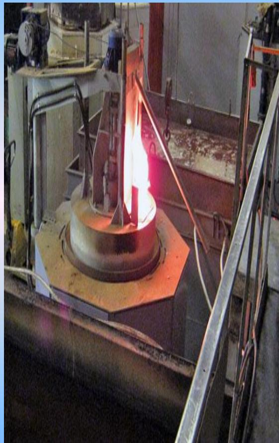
Полученный насыщенный серой слой значительно превосходит по своей противоизносности начальный. Например, в ДВС благодаря циркуляции масла наличие сульфидированных деталей приводит к улучшению работы всех трущихся пар, так как сульфиды, переносимые маслом, попадают на все поверхности трения трибосопряжений.
