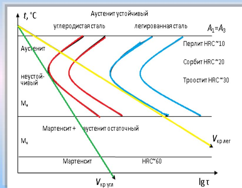
Характер распределения скорости охлаждения на поверхности и в сердцевине углеродистой и легированной стали
