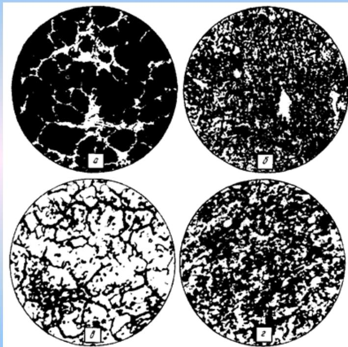
Одновременно мелкодисперсные карбиды являются препятствием для перемещения дислокаций, что приводит к повышению прочностных свойств. Элементы, которые не образуют карбидов (**никель, кобальт, кремний**), относительно слабо влияют на рост зерна.
