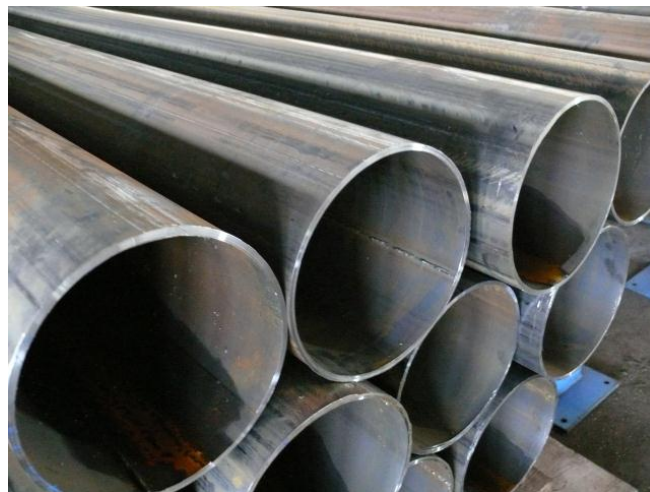
Труба электросварная (сталь низколегированная 09Г2С)
