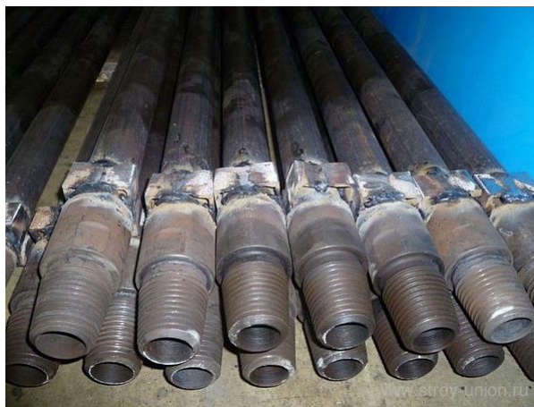
Штанги буровые с замками 3-50, 3-56, 1,5м (замок: среднелегированная сталь. Толщина стенки трубы 3,5мм.)
