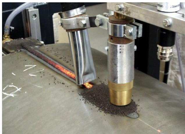
Автоматическая сварка под флюсом
