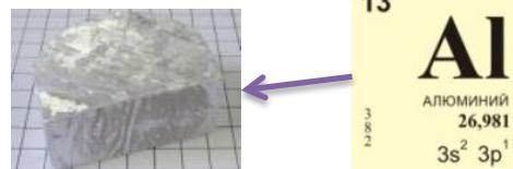
Технический алюминий АД1, АД, алюминиево–марганцевый сплав АМц ( $Al + 1,3\% Mn$ ), группа сплавов системы  $Al - Mg$ : АМг1, АМг2, АМг3, АМг4, АМг5, АМг6.
