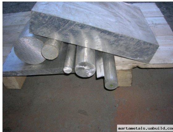
**Специфические свойства алюминия** – высокая электро- и теплопроводность, коррозионная стойкость, способность поглощать нейтроны. Алюминий – химически активный металл. Даже при нормальной температуре на его поверхности образуется **оксид**  $\text{Al}_2\text{O}_3$ .
