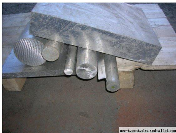
**Специфические свойства алюминия** – высокая электро- и теплопроводность, коррозионная стойкость, способность поглощать нейтроны. Алюминий – химически активный металл. Даже при нормальной температуре на его поверхности образуется **оксид**  $\text{Al}_2\text{O}_3$ .
