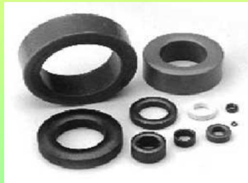
**Ферриты** – магнитная керамика – системы из оксидов железа и оксидов других, в большинстве случаев двухвалентных металлов.
