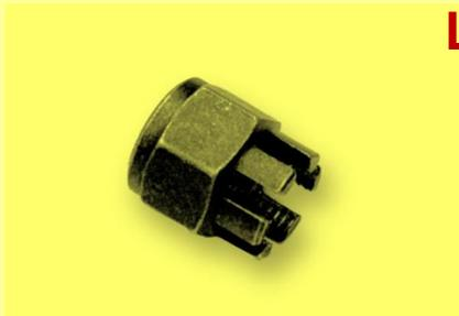
Гайка шатунного болта
