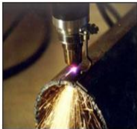
Рис. 3. Примеры использования аппарата «Мультиплаз-2 500»: a – резка различных металлов; б – сварка различных сталей
