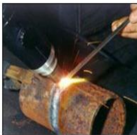
Рис. 3. Примеры использования аппарата «Мультиплаз-2 500»: a – резка различных металлов; б – сварка различных сталей
