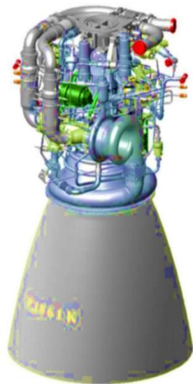
Неохлаждаемая сопловая насадка ракетного двигателя ( КБ « Южное», Украина ) [55]
