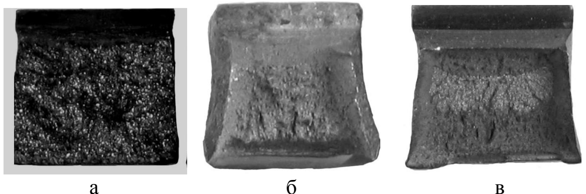
Рис. 1.1. Види зламу: а – крихкий; б – в'язкий; в – змішаний; х 7
