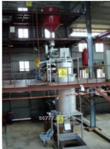
Толкательные муфельные или трубчатые печи наиболее просты по своей конструкции. Продвижение лодочек (поддонов) из графита, стали, карбида
