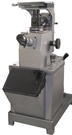
Рисунок 2.2 – Загальний вид металографічного оптичного мікроскопа МІМ-7
