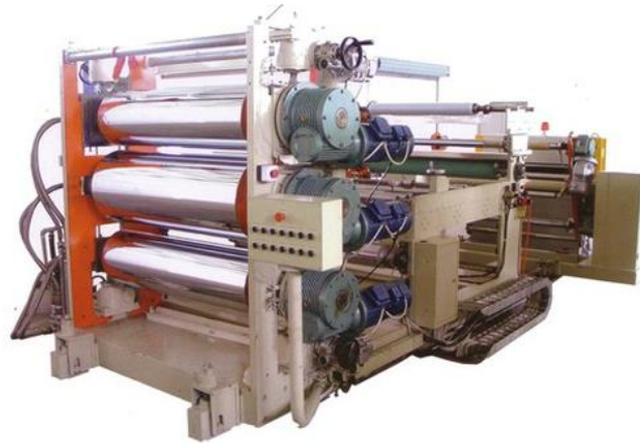
которое представляет собой два обогреваемых вала, поверхность одного из которых имеет необходимый рисунок.
