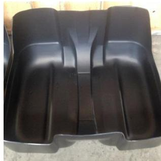
Если применяемое для вакуумной формовки пластика оборудование оснащено системами воздушного охлаждения, время остывания изделий может быть сокращено на 20-30%.
