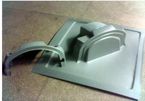
Откачка воздуха и вдавливание заготовки. После предварительного нагрева и растяжения закрепленной заготовки из аппарата для формовки производится откачка воздуха вакуумным насосом.
