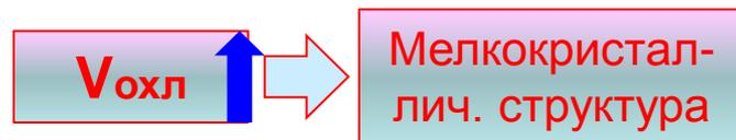
При высокой скорости охлаждения получают мелкокристаллическую структуру, так как времени на перегруппировку кристаллов недостаточно.
