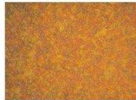
*режим 5 твердость 1618 HV, размеры карбидных включений TiC и WC 1-3мкм*
