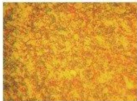
*исходный, твердость 1653 HV, размеры карбидных включений TiC и WC 1-2мкм*
