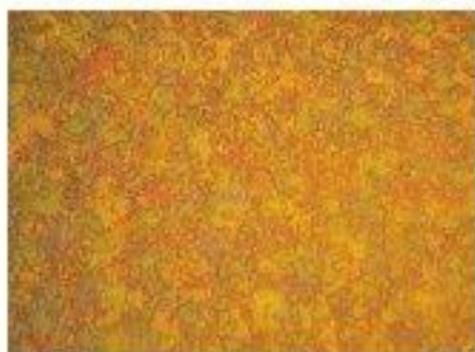
*режим 3 твердость 1566 HV, размеры карбидных включений TiC и WC 2-3мкм*
