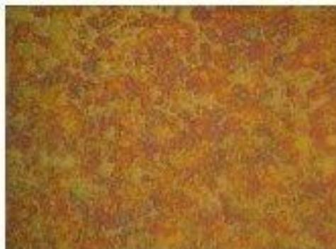
*режим 4, твердость 1588 HV, размеры карбидных включений TiC и WC 2-4мкм*
