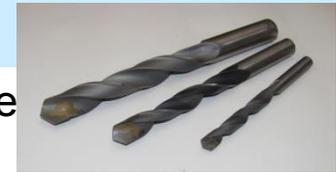
Необходимо помнить об уплотнении поверхностного слоя порошковой детали при сверлении. Развертывание отверстий в порошковых деталях после их сверления применяют с целью исправления формы, получения высоких чистоты поверхности и точности размеров. Развертки из быстрорежущей стали имеют недостаточную стойкость, особенно при скоростях > 30–40 м/мин, поэтому более **предпочтительны твердосплавные развертки.** При развертывании отверстий необходимо применять специальные охлаждающие жидкости (СОЖ).
