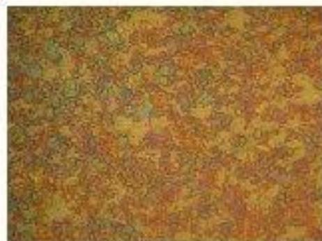
*режим 1 твердость 1623 HV, размеры карбидных включений TiC и WC 3-5мкм*
