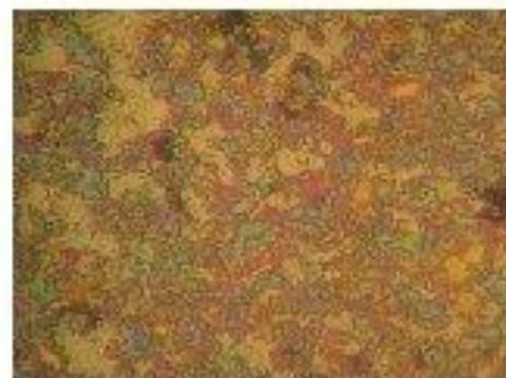
*режим 2 твердость 1695 HV, размеры карбидных включений TiC и WC 3-5мкм*
