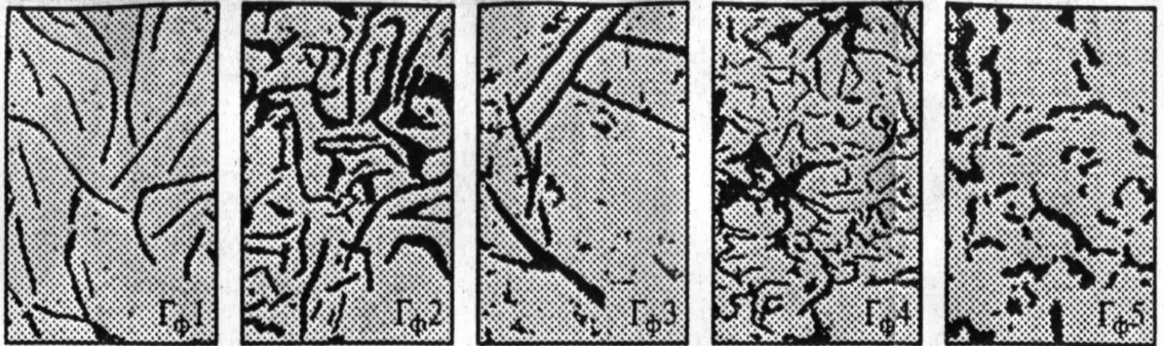
Одной из самых отличительных особенностей чугуна является зависимость его структуры от химсостава, скорости охлаждения (от толщины стенки отливки), модифицирования
