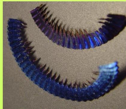
Прирезцовая сторона такой стружки гладкая, а противоположная имеет зазубрины.
