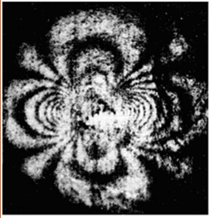
Рис. 2. Интерферометрические линии уровня упругих перемещений поверхности тела с остаточными напряжениями в окрестности зондирующей лунки.
