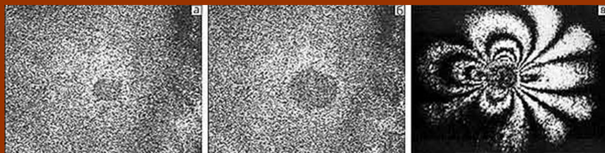
Рис. 5. Создание интерференционной картины: а, б — изображения исследуемого участка поверхности объекта до и после высверливания зондирующей лунки, в — интерференционная картина, полученная поточечным вычитанием яркостей изображения а из б.
