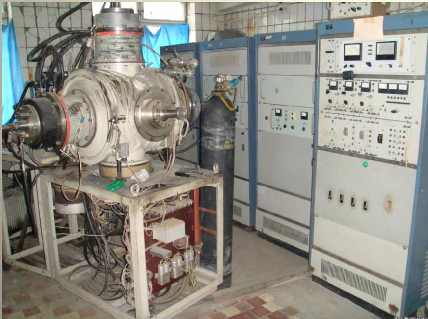
Установка ионно-плазменного напыления "Булат"
