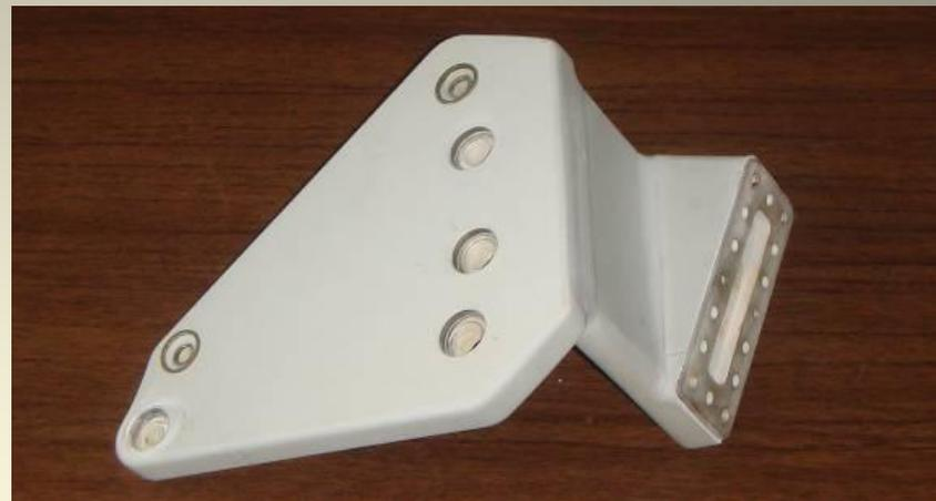
Керамическая изоляция медных шин высоковольтного трансформатора.
