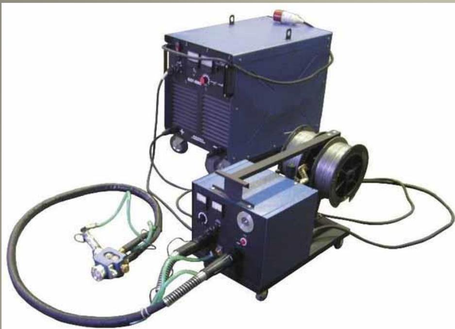
Установка «УЭМ-500-ТЛ». Принцип работы установки основан на подаче двух электропроводных проволок, оплавливающих в электрической дуге и, расплывающихся подведенным сжатым воздухом. Нанесенное покрытие образуется из-за удара расплавленных частиц и затвердеванию образовавшихся пластинок на защищаемом изделии.
