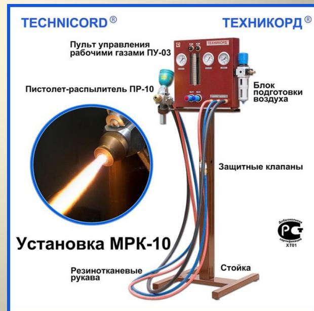
Газопламенный способ, несмотря на относительно невысокую производительность процесса, широко используется для напыления деталей с небольшим объемом восстановительных работ. Этот способ отличается высокой стабильностью процесса, простотой и низкой стоимостью используемого оборудования, хорошими санитарно-гигиеническими условиями труда, возможностью нанесения слоев значительной толщины (до 10 мм) без опасности образования трещин в покрытии и его отслоения [1].
