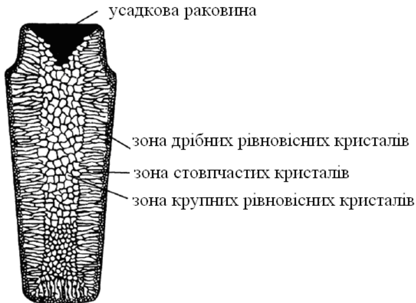
Рисунок 2.4 – Кристалічна будова зливка спокійної сталі
