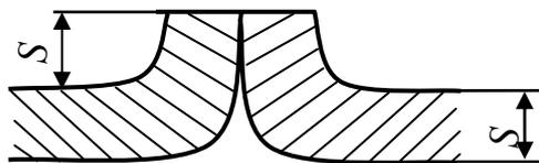
Рис. 55. Отбортовка кромок при толщине изделия 1,5–3,0 мм
