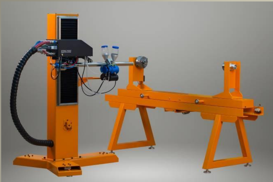
Пушка «CCDS2000» на специализированном координатном манипуляторе. 3-х роботе-
