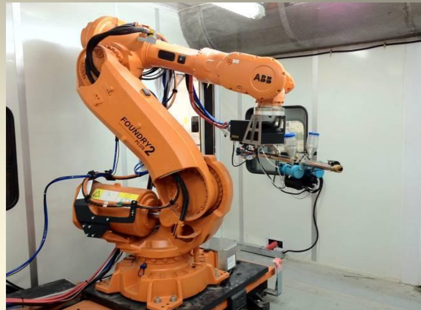
Пушка «CCDS2000» на промышленном роботе.
