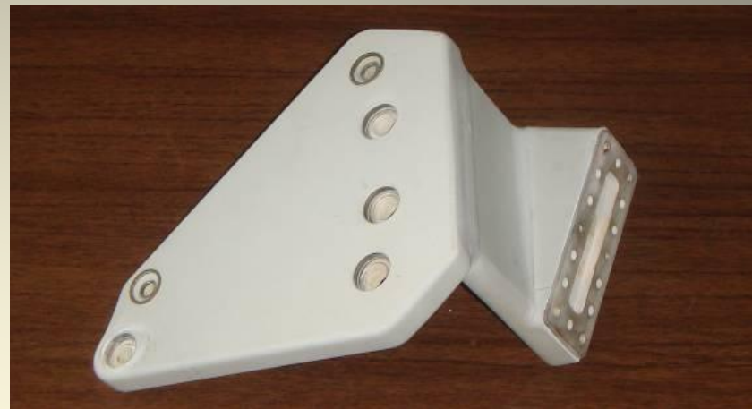
Керамическая изоляция медных шин высоковольтного трансформатора.
