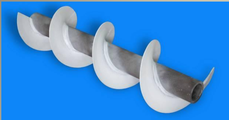
Упрочнение шнека пульпонасоса.
