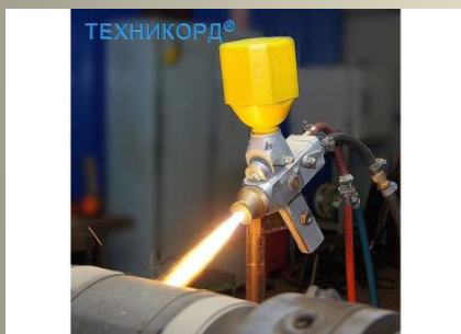
Рисунок 1 - Схема процесса газопламенного напыления покрытия
