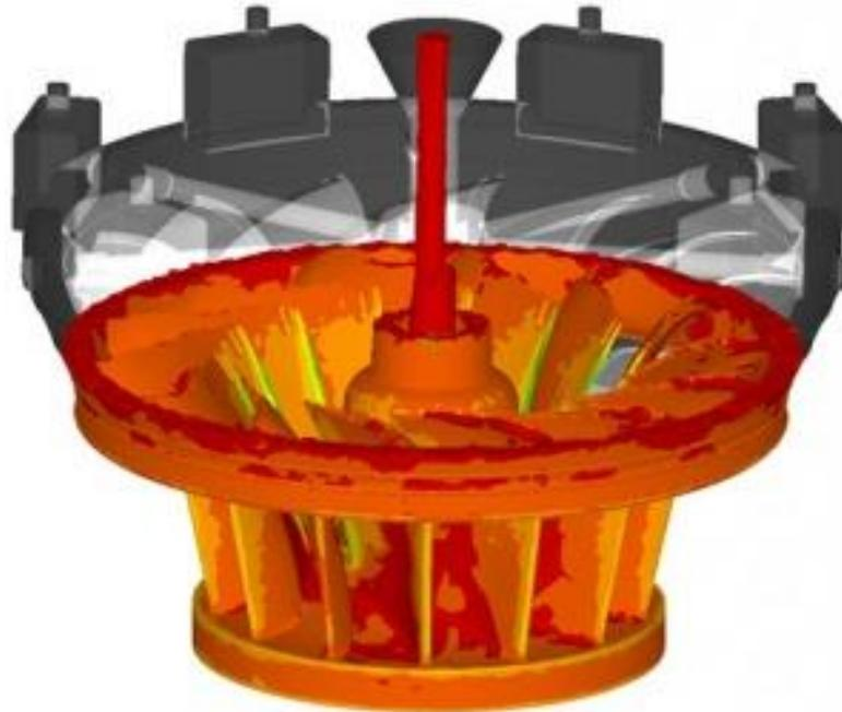
4) Повышение плотности металла с минимальным количеством неметаллических включений
