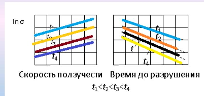
Характеристики жаропрочности металла при разных температурах: а – схема диаграммы напряжение–скорость ползучести; б – зависимость между временем до разрушения и напряжением; т – температура испытаний
