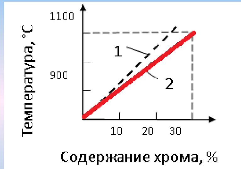
Интервал работы жаростойких сталей в зависимости от содержания хрома: 1 – аустенитные стали; 2 – ферритные стали
