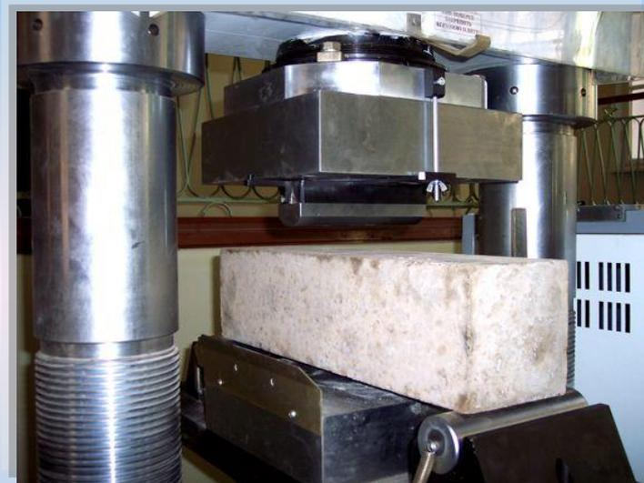
Приспособление для проведения испытания на трещиностойкость
