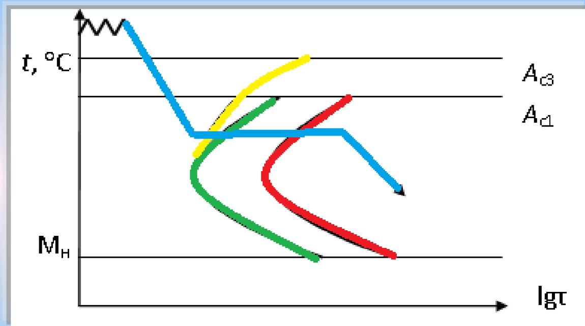
Схема высокотемпературной термомеханической изотермической обработки для доэвтектоидной стали
