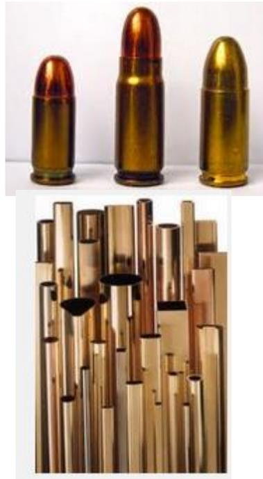
Добавка никеля и железа повышает механическую прочность до 550 МПа.
