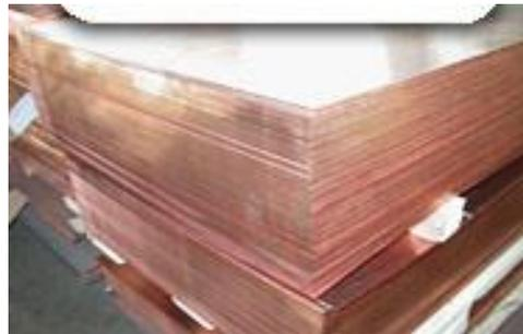
В сложных латунях каждый легирующий элемент обозначен определённой буквой: А – Al, Ж – Fe, Мц – Mn, О – Sn, С – Pb. Цифры показывают содержание элемента в процентах.
