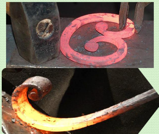
Горячая деформация - это деформация, которая происходит выше температуры рекристаллизации.
