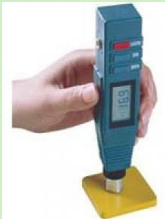
Недостатки – наличие погрешности (из-за косвенного метода измерения), калибровка проводится для определенного материала.
