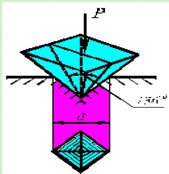
Твердость по Виккерсу имеет размерность напряжения (кгс/ мм<sup>2</sup> или МПа).
