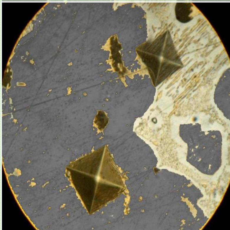
Микротвердость определяется идентификацией при нагрузке на индентор не более 2 Н. и при внедрении индентора не меньше чем на 200 нм
