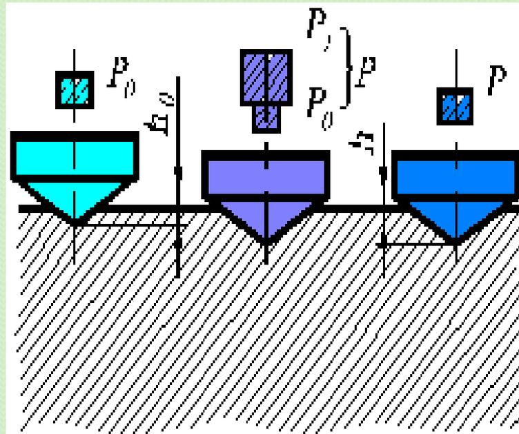
При измерении алмазным конусом используются шкалы А и С и твердость обозначается HRA, HRC соответственно. При измерении стальным шариком используют шкалу В, а твердость обозначают HRB.
