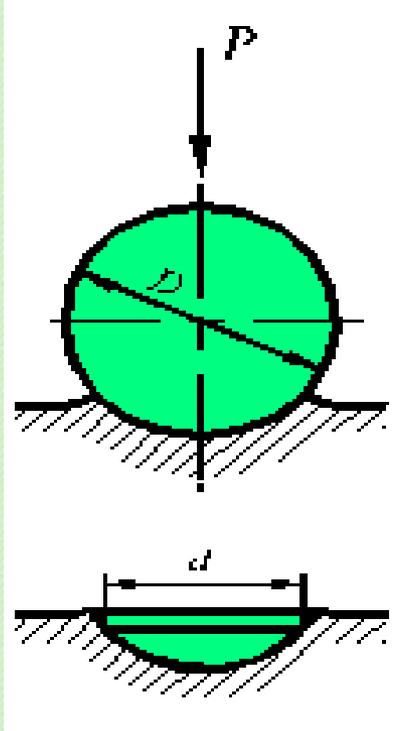
Диаметр отпечатка измеряют с помощью специальной лупы или цифрового микроскопа.
