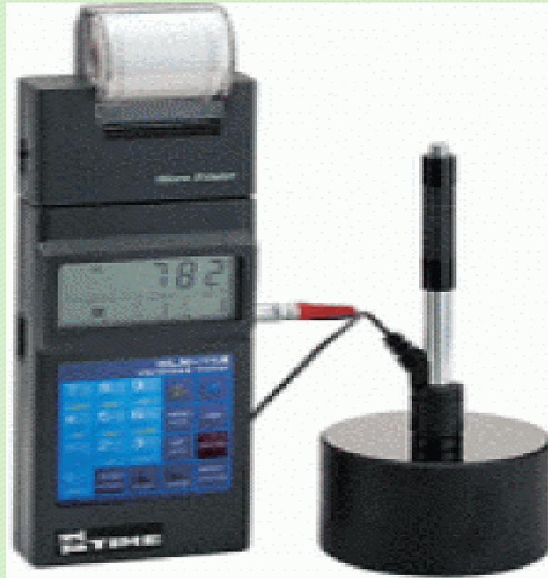
Во время внедрения пирамиды в исследуемое изделие под действием необходимой силы калиброванной пружины, происходит определение значения собственной частоты резонатора, которое определяется твердостью материала.
