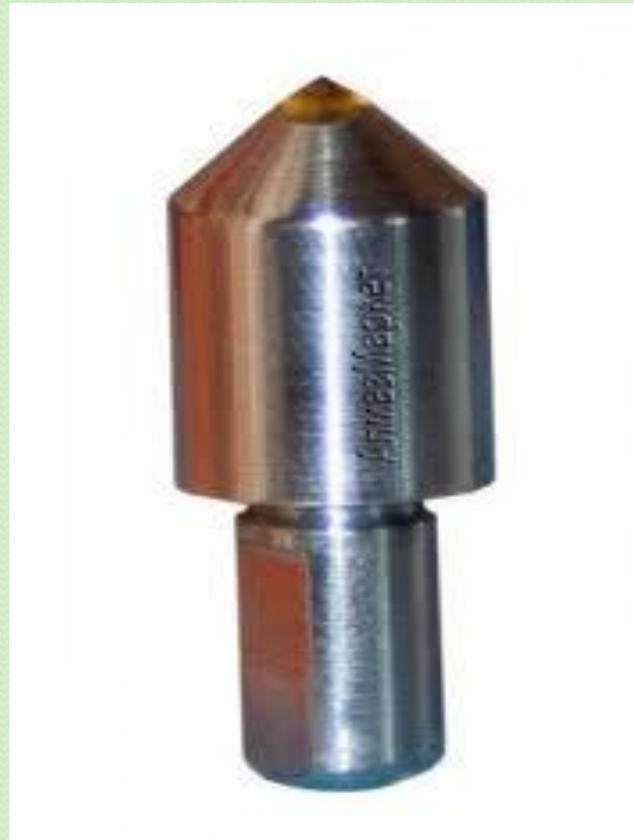
При измерении индентор вдавливается в исследуемый материал с некоторой постоянной силой. После снятия нагрузки и удаления индентора измеряются геометрические параметры отпечатка: площадь, глубина, объём и т.п.
