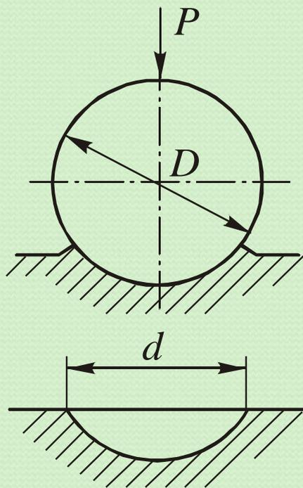
Твердость по Бринеллю ( $HB$ ) выражается отношением взятой нагрузки  $P$  к площади поверхности отпечатка  $F$ :
