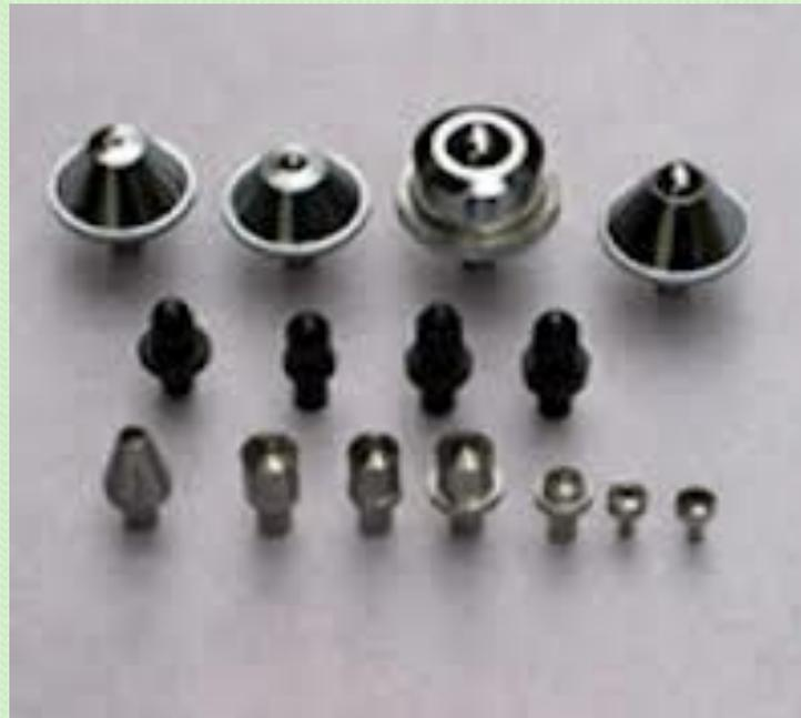
В отличие от многих других, измерения твердости является неразрушающим методом механических испытаний.
