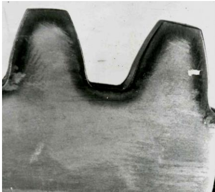
макроструктура валика, закаленного с нагревом токами высокой частоты
