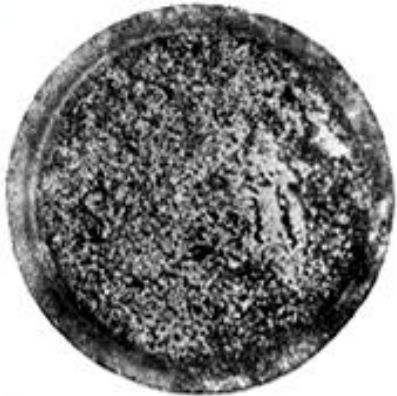
макроструктура валика, закаленного с нагревом токами высокой частоты
