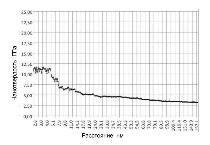
Поверхностное упрочнение ионной бомбардировкой приводит к созданию в поверхностном слое развитой субструктуры с размерами элементов в среднем ~ 600 нм и с широкими межзеренными границами ~ 200 нм.
