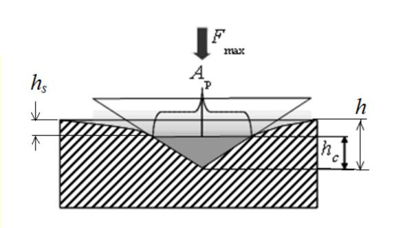
При расчете твердости индентирования используется глубина контакта индентора с материалом. Определить эту величину позволяет методика Оливера и Фарра.
