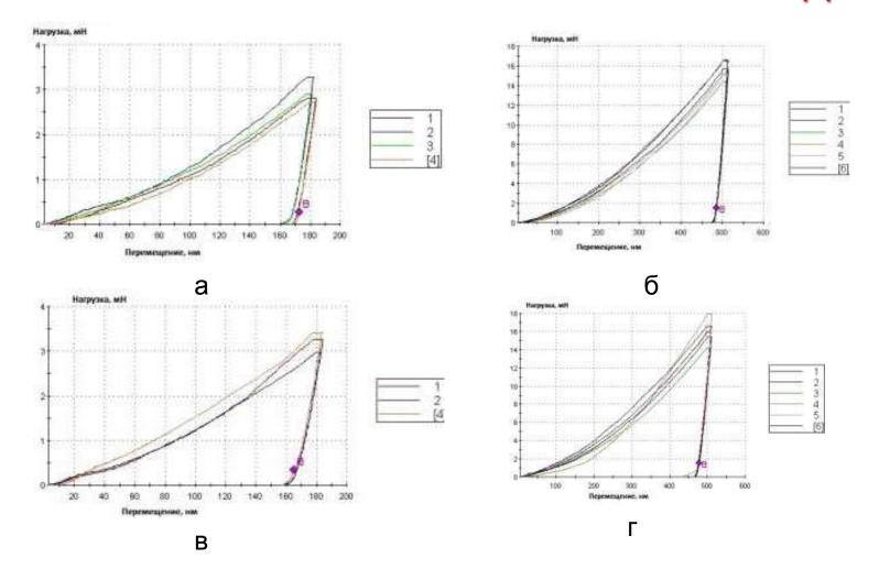
Кривые индентирования стали 20 до ИБ (а, б) и после ИБ (в, г): а, в – глубина 200 нм; б, г – глубина 500 нм
