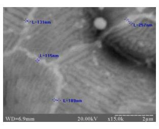
Микроструктура поверхности отожженного образца стали 20 до (а) и после ИБ (б) на сканирующем электронном микроскопе, x8000
