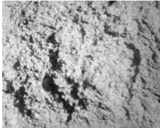
Излом кристаллический блестящий
