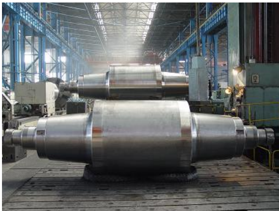
ПРОКАТНЫЕ ВАЛКИ (БЕЛЫЙ ЧУГУН В ПОВЕРХНОСТНОМ СЛОЕ)
