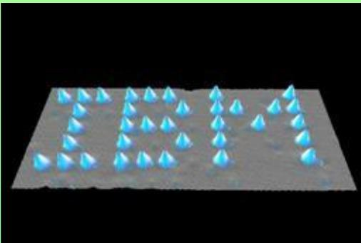
Сложенное из 35 атомов ксенона на пластинке из никеля название компании IBM, сделанное сотрудниками этой компании с помощью сканирующей зондовой микроскопии в 1990 году.
