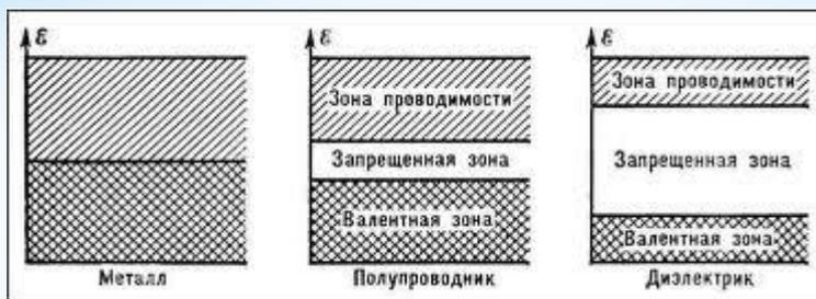
**Диэлектрики** - материалы, обладающие высоким электрическим сопротивлением (очень низкой электропроводностью), способные к поляризации во внешнем электрическом поле (в них возможно существование электростатического поля).
