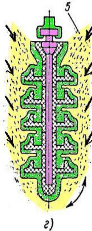
тонкий слой 4 суспензии. Для упрочнения обсыпают песком 5 (г)
