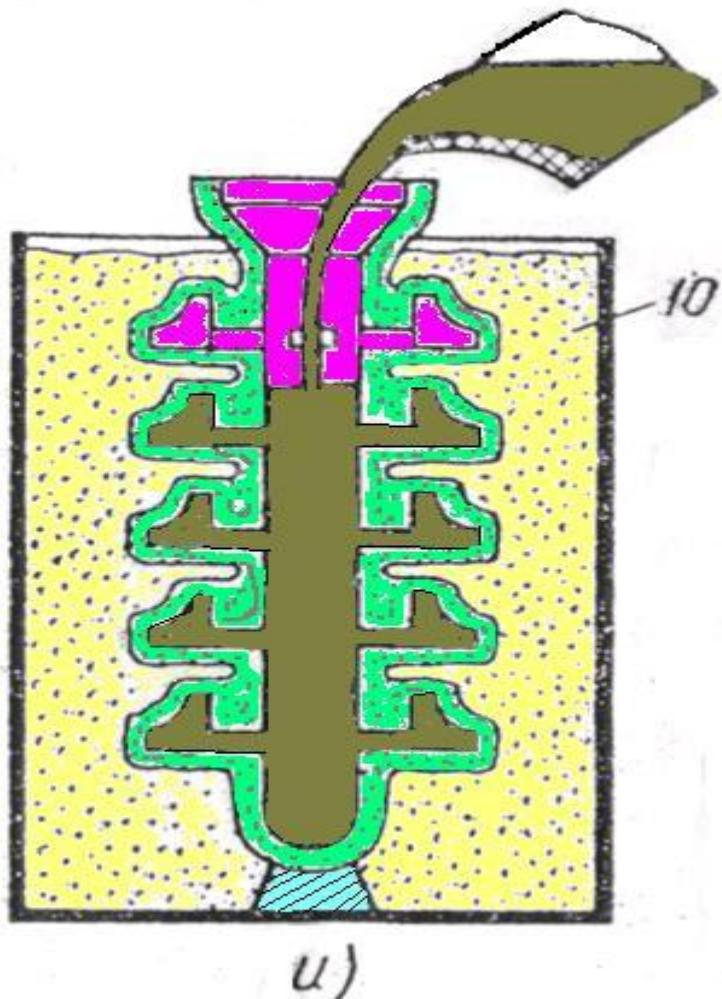
Модели отливки и литниковой системы изготавливают из материалов, имеющих невысокую температуру плавления (воск, стеарин, парафин)
