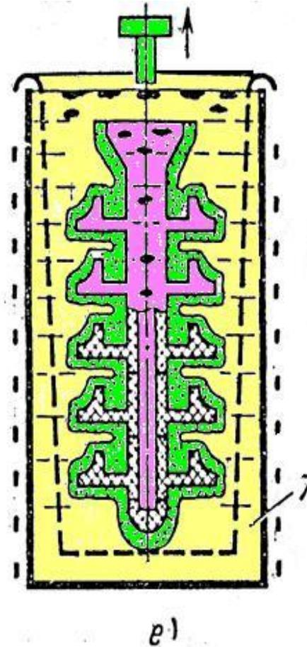
Удаление выплавляемой модели проводится в горячей воде 7 (е)
