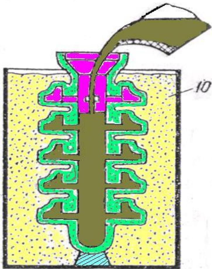
Модели отливки и литниковой системы изготавливают из материалов, имеющих невысокую температуру плавления (воск, стеарин, парафин)
